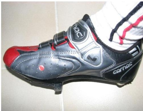
Bougez ensuite la cale pour que la marque soit alignée avec l'axe de la pédale lorsque la manivelle est au point mort bas et le pied dans sa position naturelle de pédalage. Faites le pour les 2 pieds car ils ne sont pas forcément identiques
