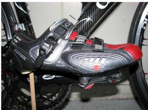
Suspendre le vélo. Fixer à vide vos chaussures sur les pédales. Observez le placement en essayant d'ajuster les axes des gros orteils au droit des axes de pédales.
